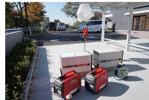
導入した可搬式発電機2台と投光器
